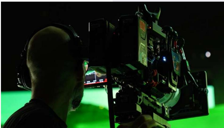
La caméra utilisée était une Red Komodo couplée aux optiques Viltrox anamorphiques. Le capteur était exploité sur tout sa largeur pour obtenir un rendu **cinémascope** renforçant l'immersion.
